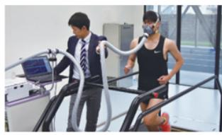
この実験室内は、酸素濃度（20.9～11.0% = 標高5,000m相当）、温度（-20～50°C）および湿度（30～80%）を自由に調整できます。この実験室を使えば高地での合宿前に、その耐性を調査することや、暑熱環境への順化トレーニングの効果などを検証することができます。
