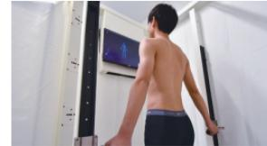
この実験室内は、酸素濃度（20.9～11.0% = 標高5,000m相当）、温度（-20～50°C）および湿度（30～80%）を自由に調整できます。この実験室を使えば高地での合宿前に、その耐性を調査することや、暑熱環境への順化トレーニングの効果などを検証することができます。
